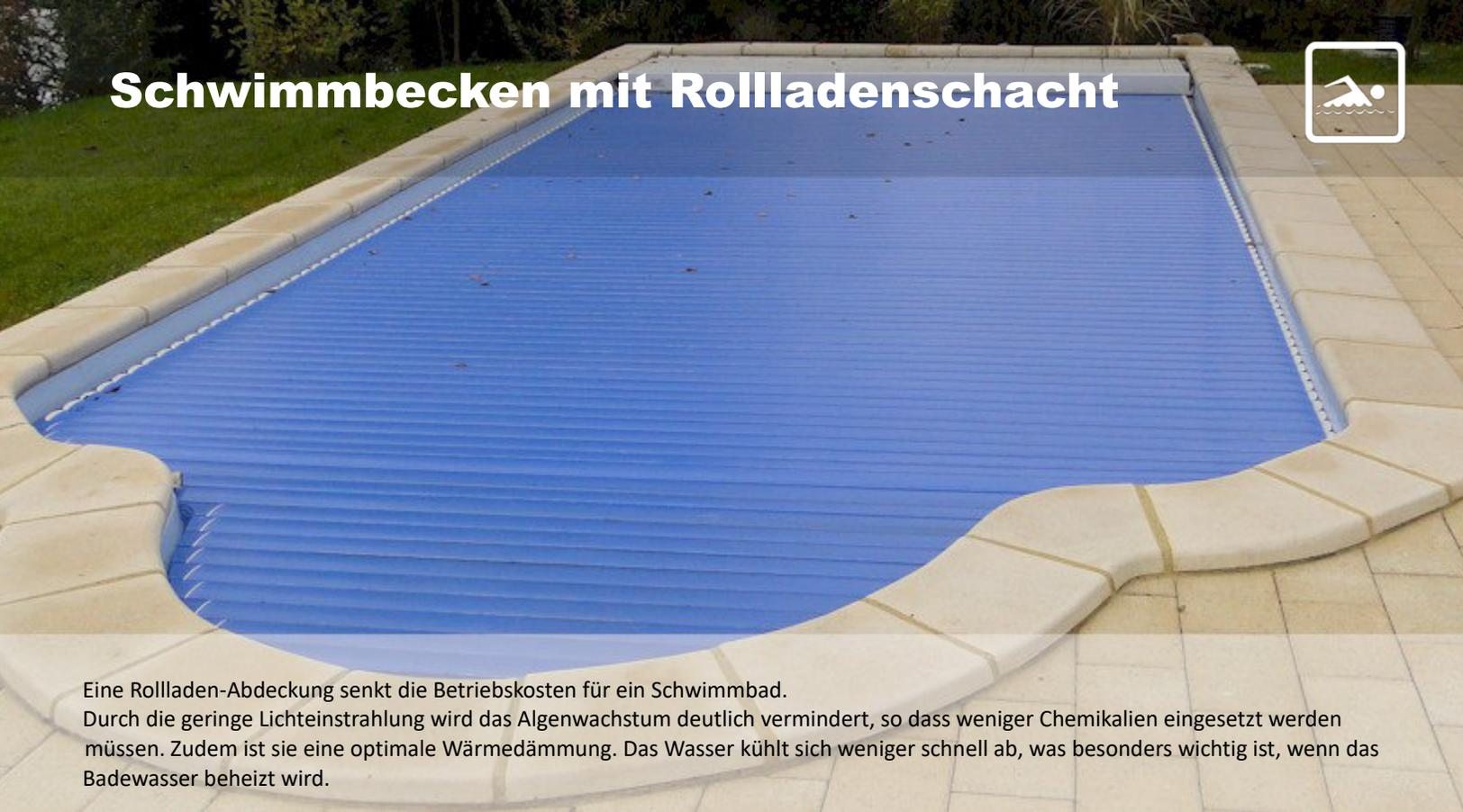
Eine Rolladen-Abdeckung senkt die Betriebskosten für ein Schwimmbad. Durch die geringe Lichteinstrahlung wird das Algenwachstum deutlich vermindert, so dass weniger Chemikalien eingesetzt werden müssen. Zudem ist sie eine optimale Wärmedämmung. Das Wasser kühlt sich weniger schnell ab, was besonders wichtig ist, wenn das Badewasser beheizt wird.
